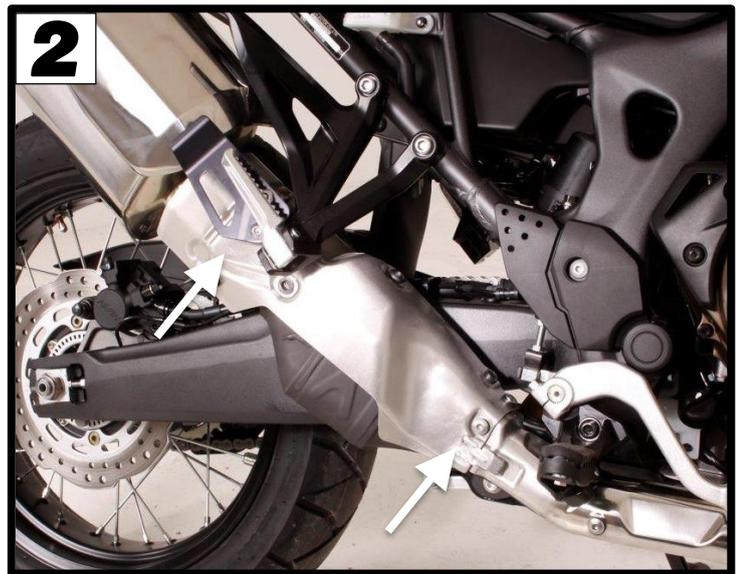
Lösen Sie die Halterschraube und die Schelle des Serienschalldämpfers und nehmen diesen ab (Abb. 3).
